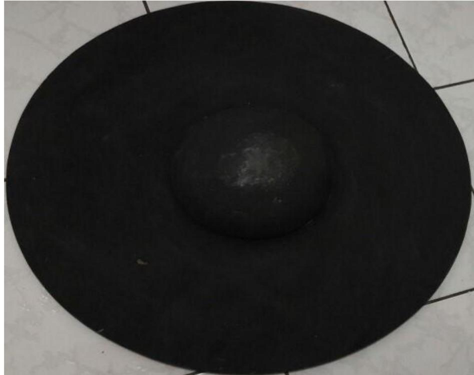
Figura 9- Base de equilíbrio da plataforma vista posterior 75 cm de comprimento e 50 cm de largura, 03 cm de espessura.
