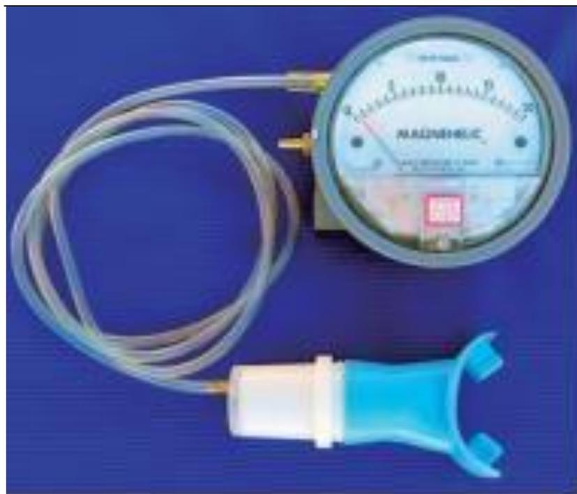
Figura 5: Representação do monovacuumetro medidor de pressão mecânica
