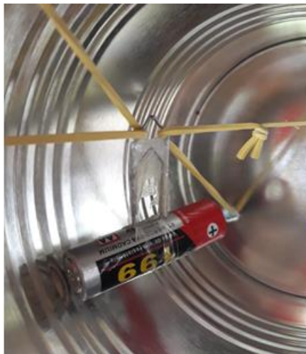
Figura 6 – Isolamento do arame e posição dos elásticos
