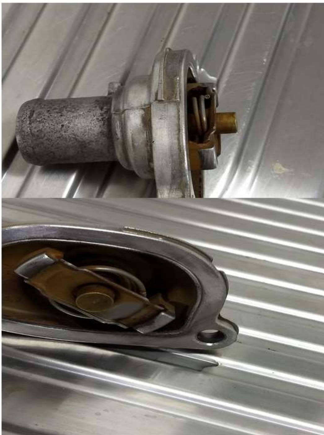
Figura 9 - Válvula termostática, fechada após ter colocado em temperatura ambiente
