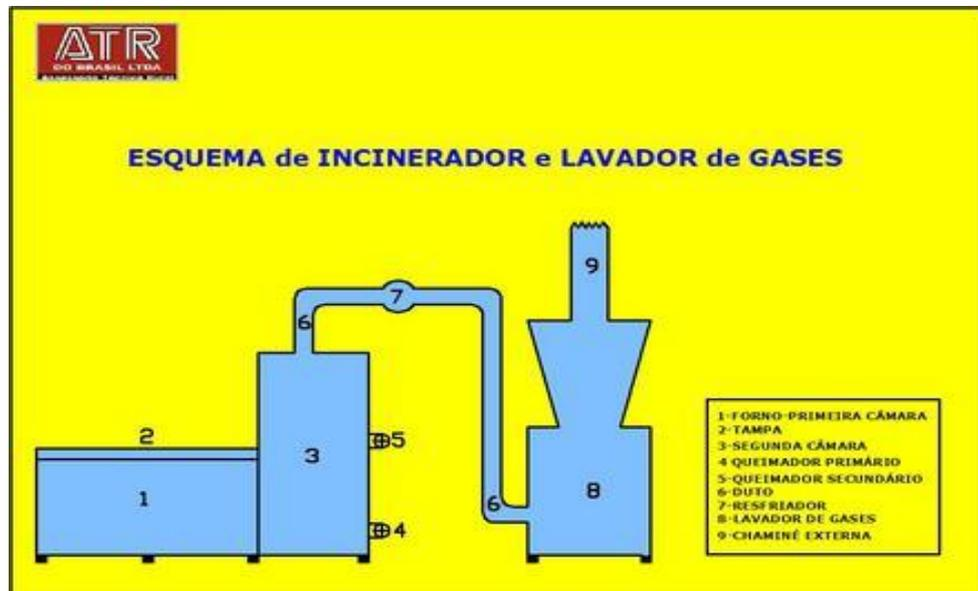
Figura 4: Esquema de incinerador e lavador de gases.
