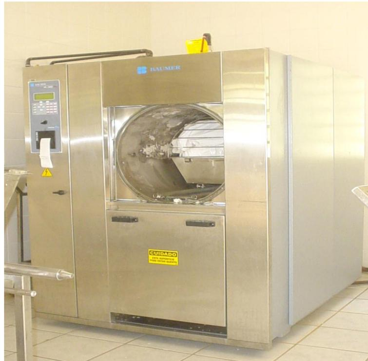
Figura 3: Imagem Autoclave para tratamento de lixo hospitalar
