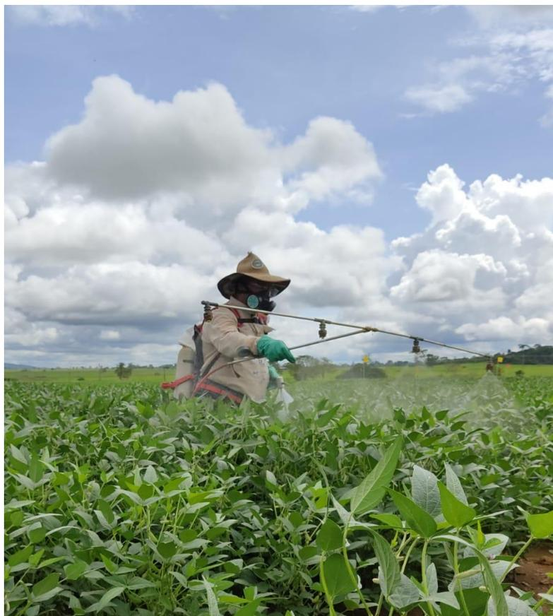
**Figura 2.** Aplicação dos tratamentos com pulverizador costal de pressão constante CO<sub>2</sub> (SILVA, 2022).
