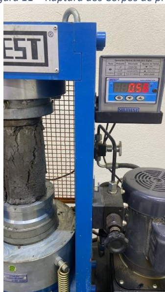
Figura 11 – Ruptura dos Corpos de prova
