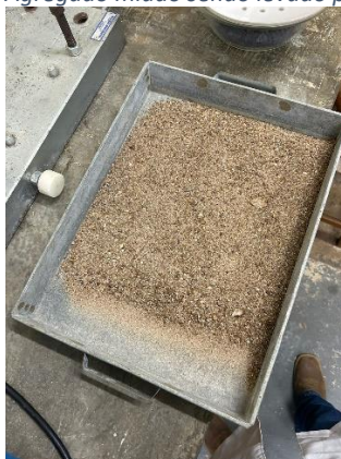
Figura 2 - Agregado miúdo sendo levado para estufa
