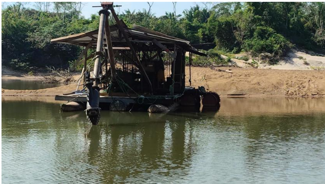
Figura 3 – Atividade produtiva de extração de areia no Vale do Jamari (RO), destacando o uso de dragas.
