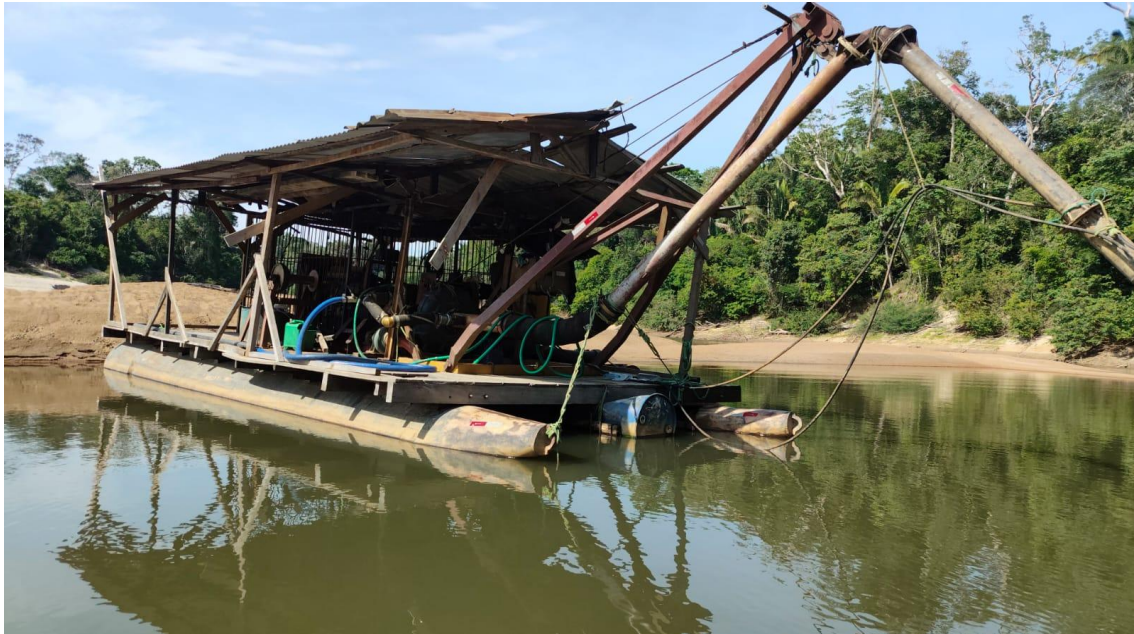
Figura 2: Processo de dragagem de areia no Vale do Jamari (RO).
