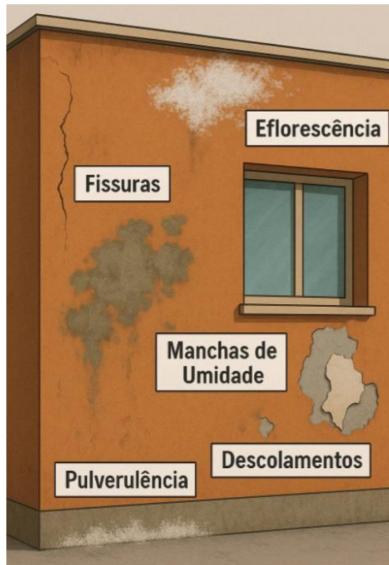
Figura 1 - Representação esquemática das principais manifestações patológicas em revestimentos de argamassa
