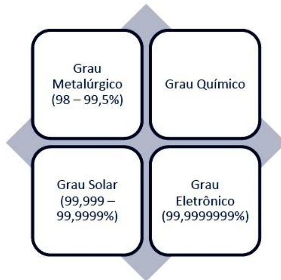
Figura 12: Níveis de pureza nos diferentes graus do silício. Fonte: MARQUES, 2013.
