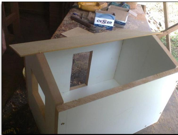
Figura 18 - Fixando o telhado.
