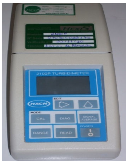
Figura 3 - HACH 2100P Portable Turbidimeter, aparelho para medição de turbidez Fonte: Arquivo pessoal
