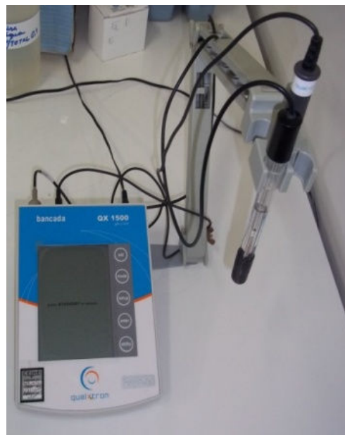
Figura 5 - QUALXTRON – QX 1500, utilizada na medição de pH da água
