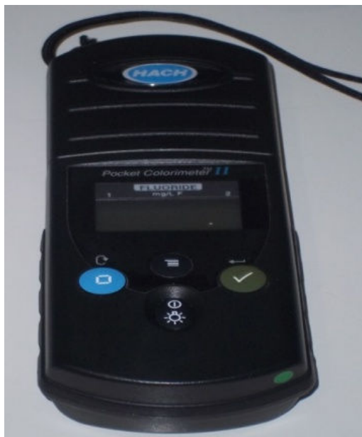
Figura 4 - HACH Pocket Colorimeter For Fluoride MKII, aparelho utilizado para medir o flúor
