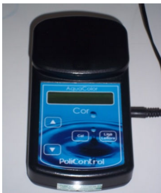
Figura 2 - Aquacolor – PoliControl, Fotocolorímetro digital para análise de cor natural nas águas Fonte: Arquivo pessoal
