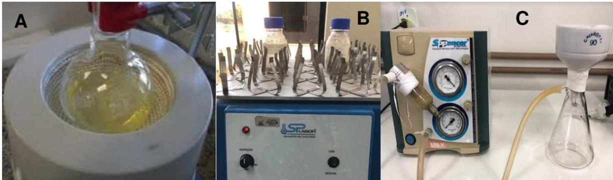
**Figura 11:** A: Processo de extração hidroalcoólica por Soxhlet; B: Shaking; C: Processo de filtração de todos os extratos
