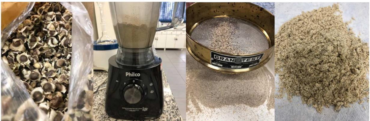
**Figura 9:** Processo de trituração e tamização das sementes da Moringa
