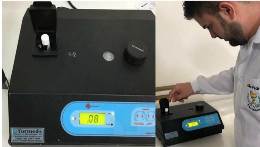
**Figura 13:** Medida da absorvância no espectrofotômetro
