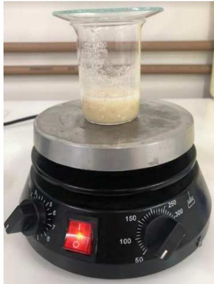
**Figura 10:** Processo de extração aquosa
