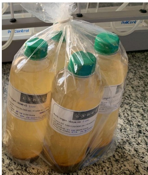
Figura 16. Amostras de lodo provenientes da descarga dos decantadores.
