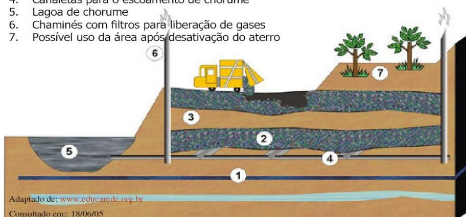
**Figura 1:** Estrutura do Aterro Sanitário
