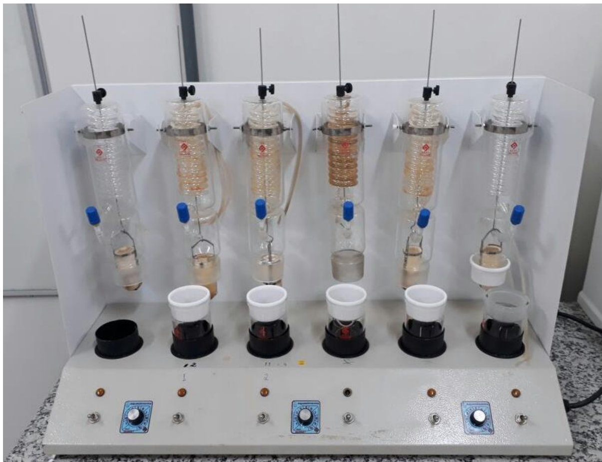
Figura 5: Extrator de Soxhlet, modelo Q308G, marca QUIMIS®
