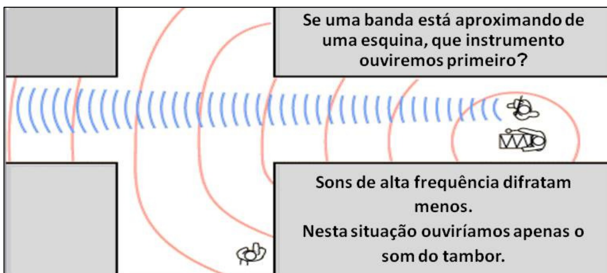
Figura 04: Ilustração da difração de sons de alturas diferentes. Fonte: BRÜEL & KJAER, 2000.
