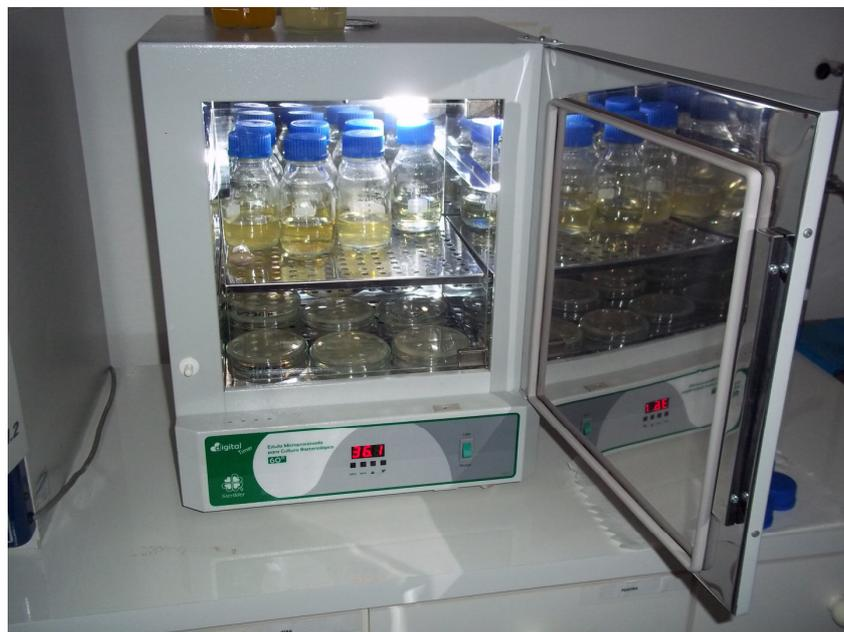
Figura 5 – Estufa Microprocessadora para Cultura Bacteriológica marca Sterilifer
