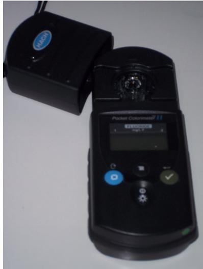
Figura 7 – Fluorímetro da marca HACH
