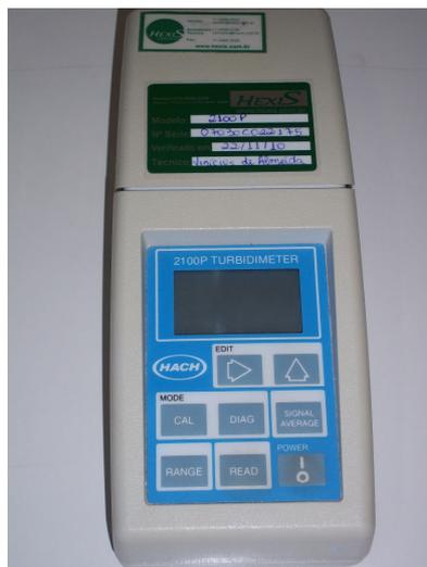
Figura 8 – Turbidímetro da marca HACH modelo 2100P
