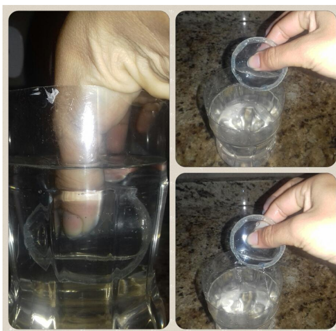
Figura 16 – Teste de vazamento
