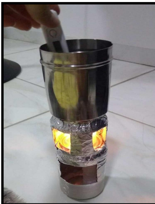
Figura 12 - Medindo a temperatura do óleo a cada um minuto, por três vezes
