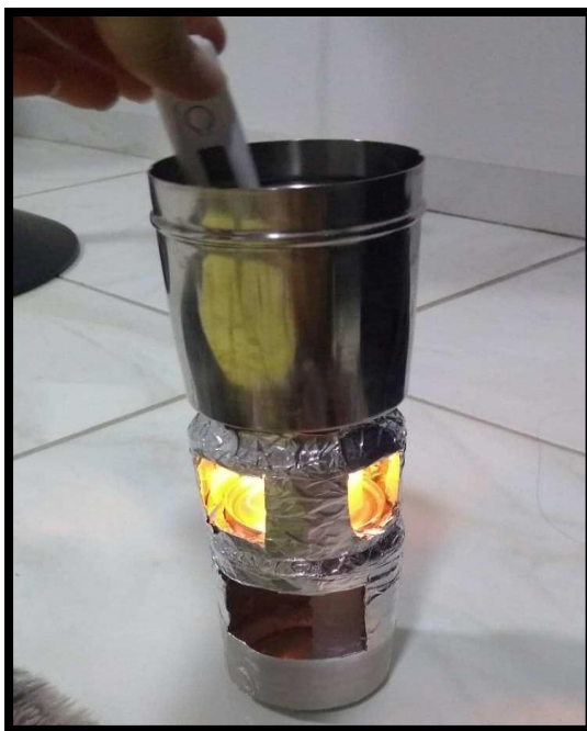
Figura 10 - Medindo a temperatura da água a cada um minuto, por três vezes.
