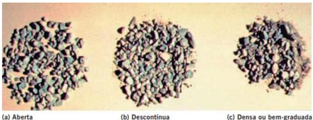
Figura 11 – Representação da graduação dos agregados utilizados na composição
