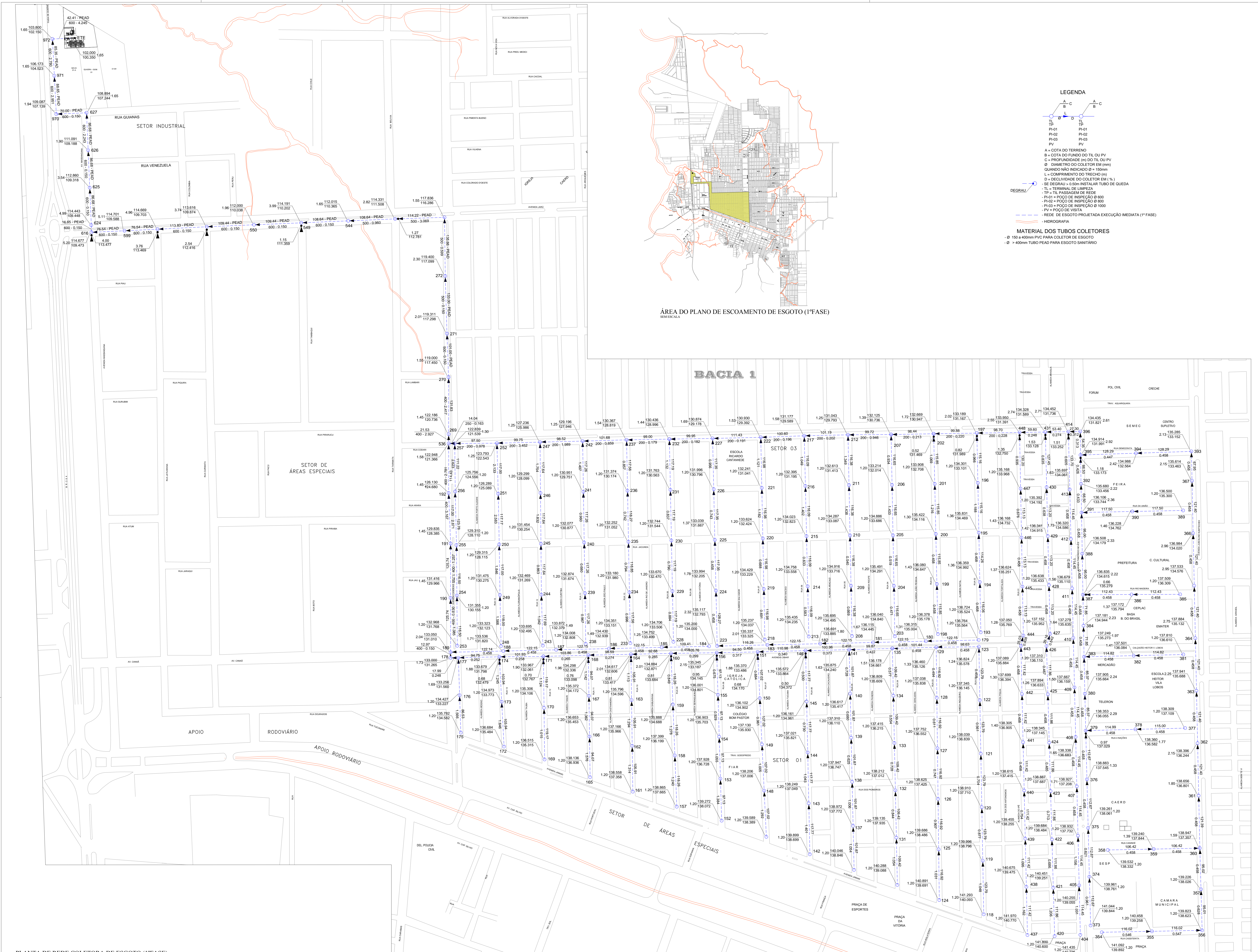
PLANTA DE REDE COLETORA DE ESGOTO (1ª FASE) ESCALA 1:2000
