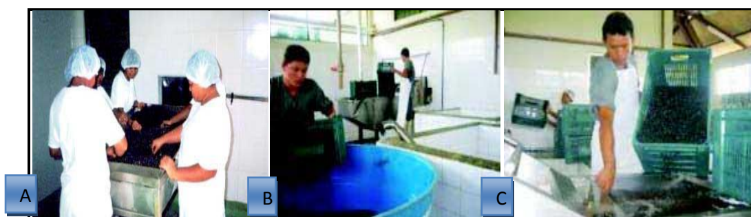
Figura 3- a) Mesa para a seleção manual de frutos de açazeiro. b) Primeira lavagem de frutos de açazeiro. c) Segunda lavagem de frutos de açazeiro.
