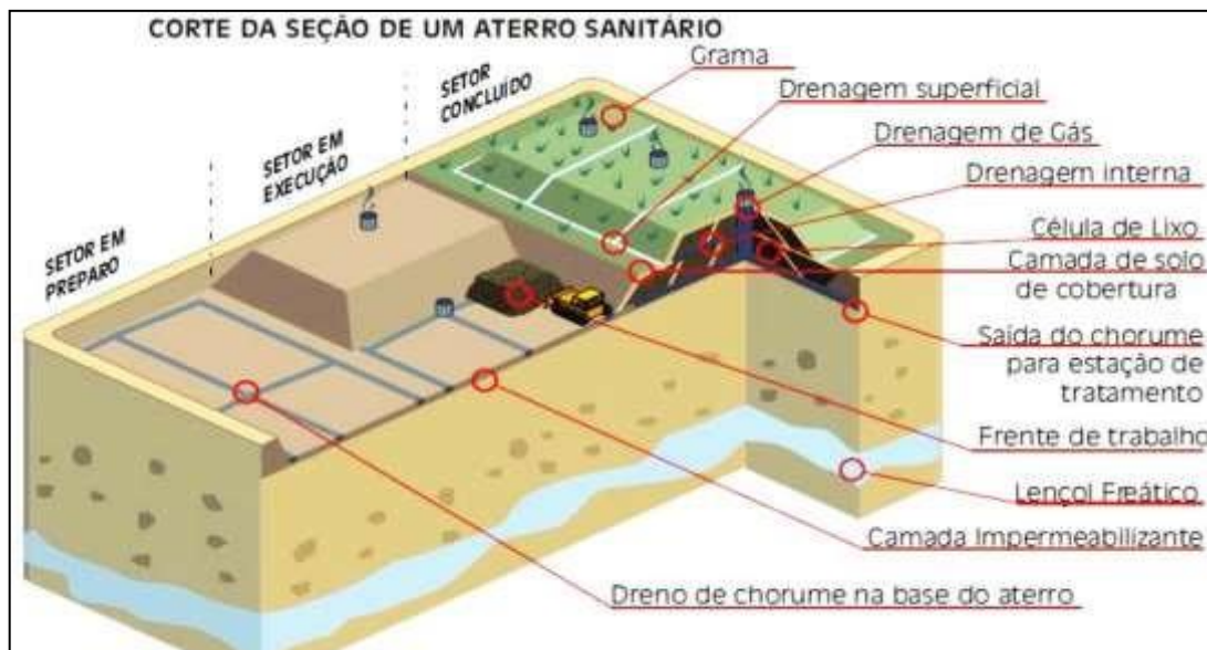
Figura 2 – Estrutura de um aterro sanitário
