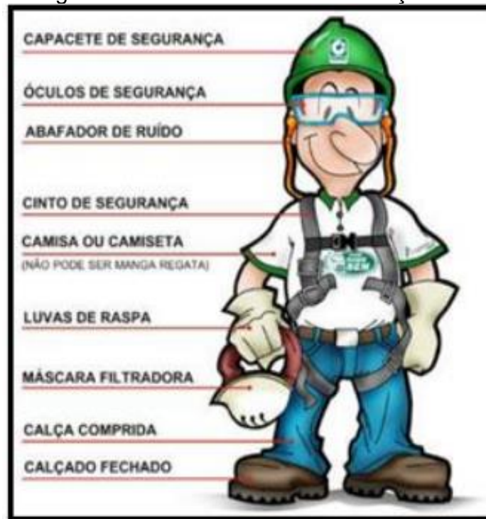
Figura 3 - Uso dos EPI's na construção civil
