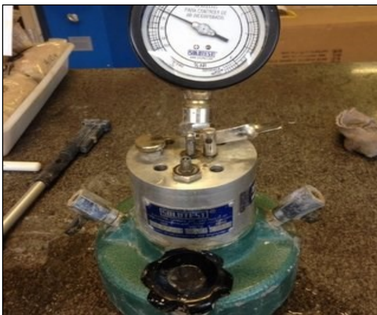
Figura 15. Determinação do teor de ar incorporado
