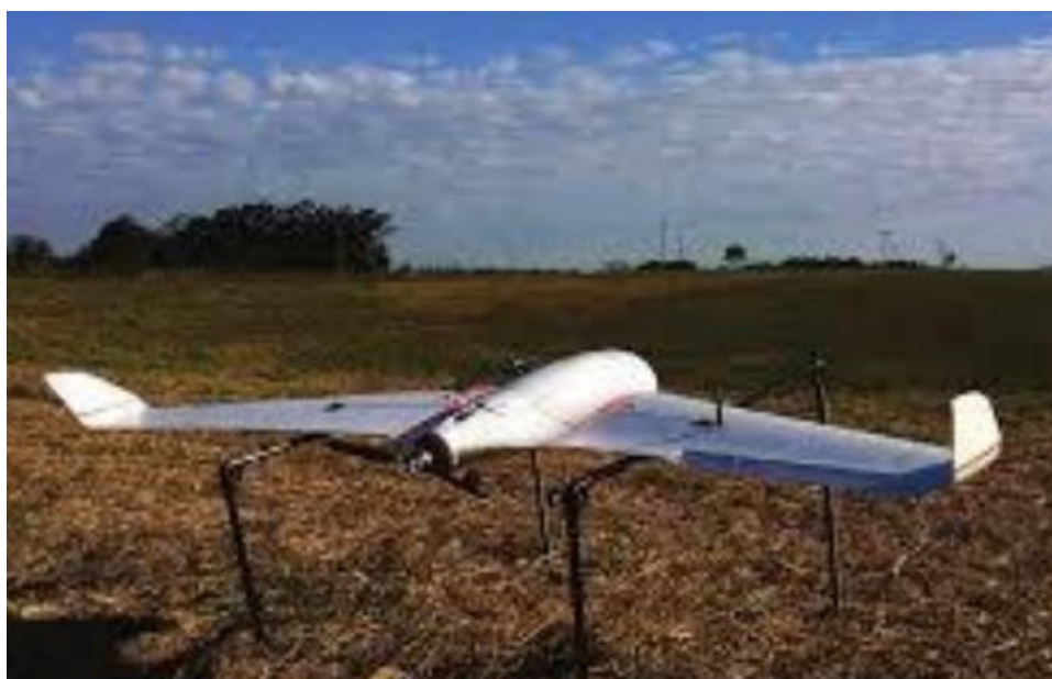
Figura 1: Plataforma X8 pré-modificações, posicionada na catapulta
