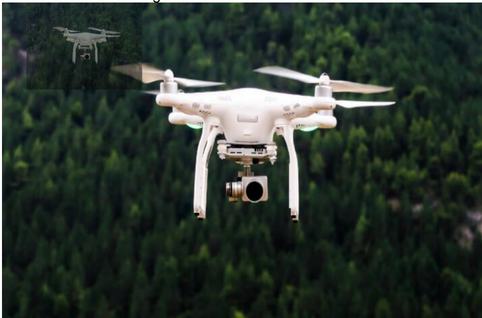
Figura 8 - Drone de asa rotativa
