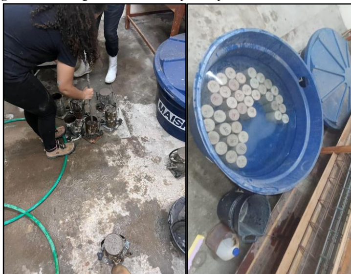
Figura 3 - Moldagem e cura dos corpos de prova cilíndricos de concreto
