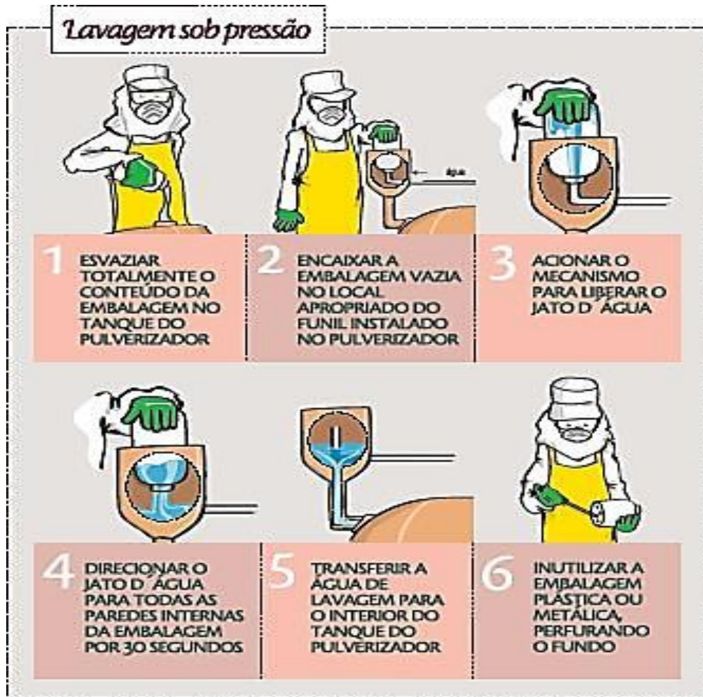
Figura 3. Etapas do procedimento de lavagem sob pressão Fonte: inpEV, 2006
